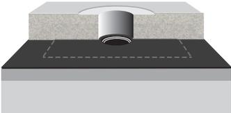
Wärmedämmung entsprechend den Ausmaßen des Etageneinsatzes aussparen. **Wichtig:** Der Flansch des Etageneinsatzes soll möglichst oberflächenbündig in die Wärmedämmung eingelassen werden.
