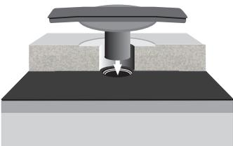
Dichtelement in den Klemmring des Ablauftopfes einsetzen. Dichtelement innen und Einschubrohr des Etageneinsatzes außen mit LORO-Gleitmittel einstreichen. Etageneinsatz rückstausicher in den Ablauftopf einsetzen. Aufbauhöhen/Wärmedämmungsdicken siehe Seite 8.
