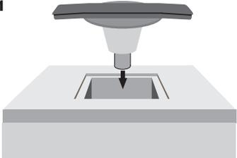
**1** Ablauftopf mit Anschlussmanschette in Deckenaussparung einsetzen (Aussparungsmaße siehe Seite 8). Die Anschlussmanschette aus Bitumen/EPDM ist mit der Bitumenschicht nach oben werkseitig in den Ablauftopf eingeklemmt, zusammen gefaltet und mit einer Schutzfolie versehen. Der Flansch des Ablauftopfes soll möglichst oberflächenbündig und sauber in die Unterlage eingelassen werden. Danach wird der Ablauftopf in der Aussparung einbetoniert.
