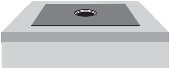
Vor Beginn der Abdichtungsarbeiten muss die Schutzfolie entfernt und die Anschlussmanschette entfaltet werden. Bei Verzögerung der Arbeiten ist die entfaltete Anschlussmanschette bauseits vor Beschädigung zu schützen.
